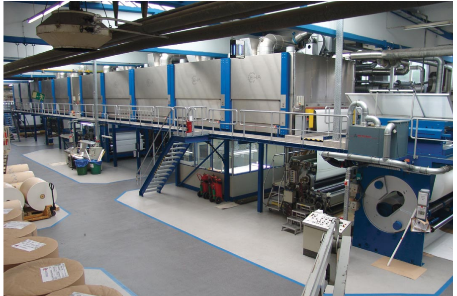
B. Laufenberg produziert Silikonpapiere und Folien, die klebende Teile von Produkten abdecken. Die Anlagen können bis zu 350 Millionen Quadratmeter im Jahr beschichten.
